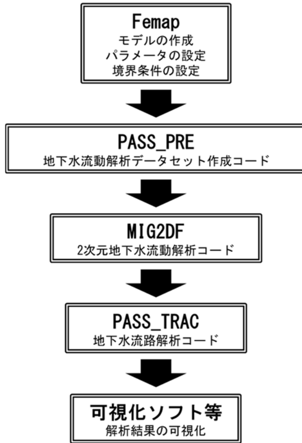
図 3-1 二次元地下水流動解析フロー
